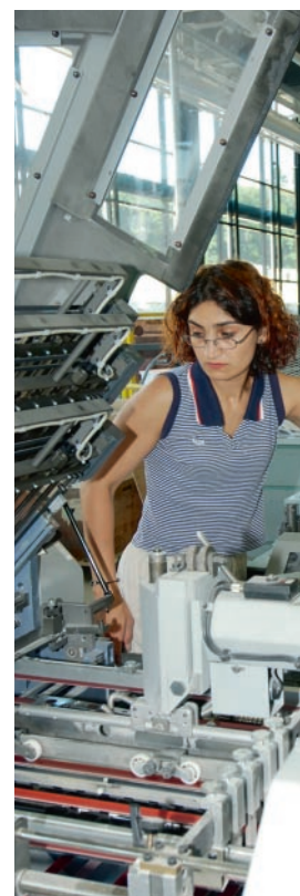
La poligrafa deve lavorare su due schermi se vuole trattare dei prodotti molto elaborati (foto sopra). L'introduzione della superficie d'impressione oggi è solitamente automatizzata, ma deve essere controllata da un tecnico prima della stampa (foto al centro a destra). Il cliente sceglie il foglio definitivo con il tecnico e impartisce il cosiddetto «visto si stampi» (foto al centro a sinistra). La programmazione e il monitoraggio di una piegatrice richiedono conoscenze da parte dell'addetta ai media stampati (foto sotto). Foto: Viscom
